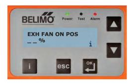
IN THE SETTINGS MENU SCROLL DOWN TO EX FAN ON POS AND SET THE PERCENTAGE OF O/A THE POWER EXHAUST WILL COME ON AT
