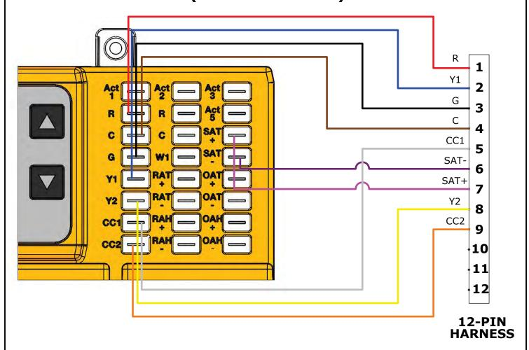
CONNECT 12-PIN ECONOMIZER HARNESS TO UNIT PL-6 HARNESS (SEE PG 5/10) HANGING TO THE LEFT OF THE UNITS FILTERS. (MAKE SURE RED WIRES LINE UP FOR ORIENTATION OF HARNESS)
