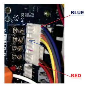
CONNECT 10-PIN 7-WIRE HARNESS FROM ZIP MODULE IN ORIENTATION SHOWN
