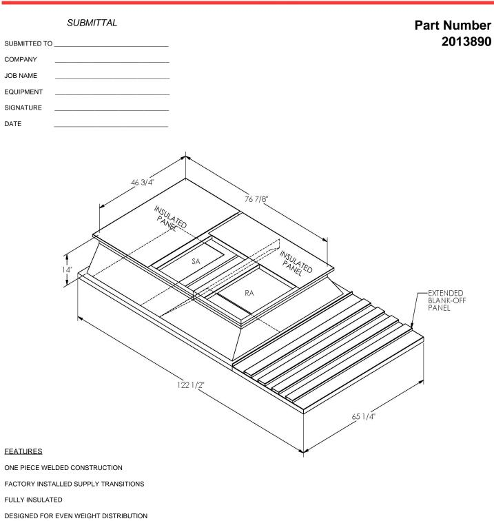
FABRICATED OF HEAVY GAUGE G90 GALVANIZED STEEL
